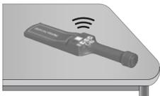
Quando il dispositivo viene posato orizzontalmente su una superficie che contiene metallo con gli indicatori rivolti verso l'alto, andrà in modalità stand-by automatica subito dopo aver emesso un allarme per un secondo.
