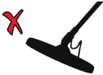
Unghi incorect al bobinei
