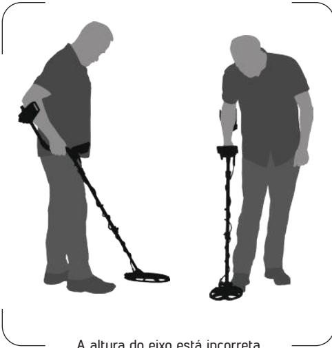
A altura do eixo está incorreta
