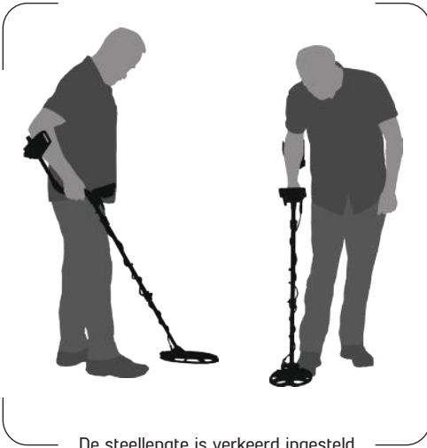
De steellengte is verkeerd ingesteld
