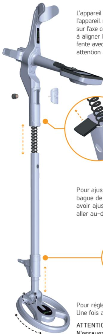
L'appareil est livré démonté en 2 parties. Pour assembler l'appareil, retirez d'abord la petite mousse de protection du câble sur l'axe central et jetez-la. Ensuite, emboîter les cannes de sorte à aligner les trous. Placez ensuite la pièce en plastique dans la fente avec la marque vers le haut. Enfin, serrez le boulon. Faites attention à ne pas endommager le câble pendant ce processus.
