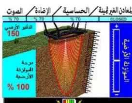
اذا تم ضبط الارض ولم يكن هناك تأثير على الجهاز تظهر عبارة تم ضبط التربة ١٠٠ % على جانب الشاشة الاسفل في هذه الحالة يكون الجهاز جاهز للاستخدام ثم نضغط على زر الموافقة للانتقال الى شاشة البحث.
