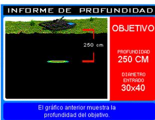
Ahora usted podrá empezar a determinar las dimensiones del objetivo. Para hacer esto, mueva la bobina hacia el objetivo. Usted querrá acercarse al objetivo del lado de la bobina. Tome en cuenta que la parte frontal y trasera de la bobina no son usadas durante la medición. Marque los primeros puntos en los cuales usted recibe una señal en cuatro direcciones. De esta manera se determina el diámetro del objetivo.
