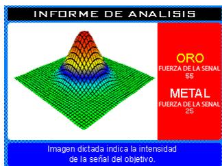
Para obtener un análisis del objetivo detectado durante su búsqueda, retire la bobina del objetivo después de ubicarlo y luego presione el botón RESET.
