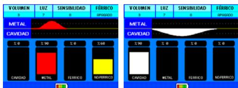
El análisis de la forma de señal de objetivo puede ser monitoreado en tiempo real en el gráfico (Osciloscopio) ubicado sobre estas barras.
