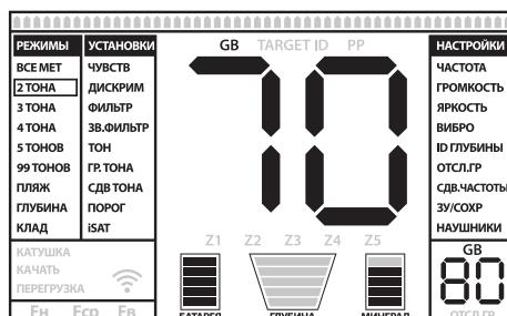
В некоторых местностях полное устранение помех от почвы невозможно. В таком случае, убедитесь в том, что прибор верно отстроен от грунта, двигая катушку вверх-вниз к земле и вслушиваясь в звуковые сигналы прибора. Если звуковые сигналы при большом и малом удалении катушки от почвы одинаковы, ваш прибор отстроен правильно.
