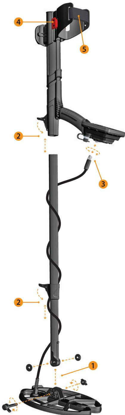
[1] Вставьте шайбы в нижнюю штангу, а затем присоедините нижнюю штангу в соответствующем месте к поисковой катушке. Закрепите поисковую катушку с помощью гайки и болта. Не затягивайте болт слишком сильно.
