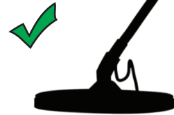
Ángulo correcto de la bobina de búsqueda
