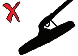
Ángulo incorrecto de la bobina de búsqueda
