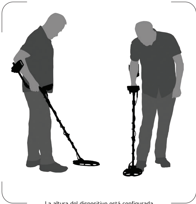
La altura del dispositivo está configurada incorrectamente
