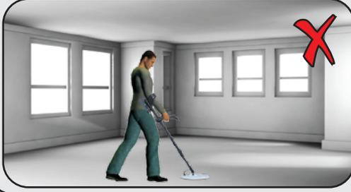
يجب عدم استخدام الجهاز في الأماكن المغلقة التي يوجد بها العديد من المعادن مثل المنازل لأنه يعطى اشارات اهداف خاطئة . استخدم الجهاز في المناطق المفتوحة .
