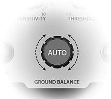
5. Si se selecciona el modo todos los metales, ajuste el umbral a un nivel donde todavía pueda escuchar las pequeñas señales. Si el detector de metales de tierra recibe una gran cantidad de ruido en el modo todos los metales y está causando una perturbación en el umbral de estabilidad del valor iSAT, aumente gradualmente hasta que el detector de metales se estabilice.
