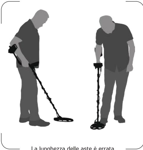
La lunghezza delle aste è errata
