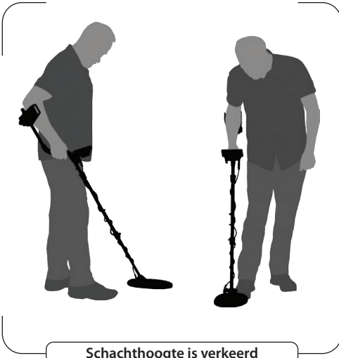
Schachthoogte is verkeerd
