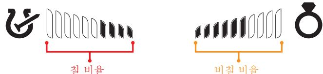
큰 철, 녹슨 못, 병뚜껑과 같은 표적에는 철 및 비철 신호가 모두 포함되어 있으며 이러한 유형의 대상물은 대상물 ID 및 오디오 응답만으로 구별할 수 없습니다. 이러한 유형의 대상물은 비철 오디오 응답과 타겟 ID를 생성할 수 있습니다.
