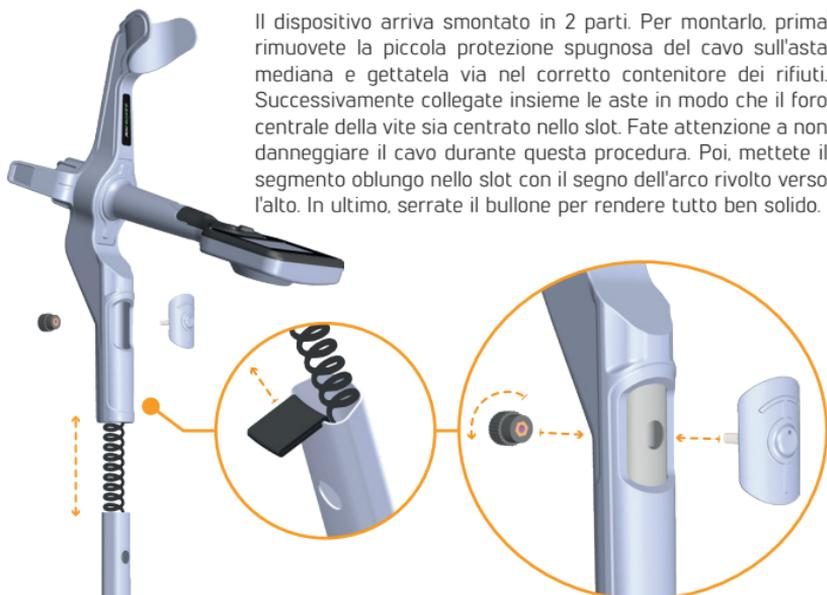
Per regolare la lunghezza dell'asta in base all'altezza, aprite la chiusura a leva. Sfilate l'asta terminale e dopo aver regolato la lunghezza, richiudete la chiusura a leva per bloccarla. Non sfilate l'asta oltre il segno "max".
