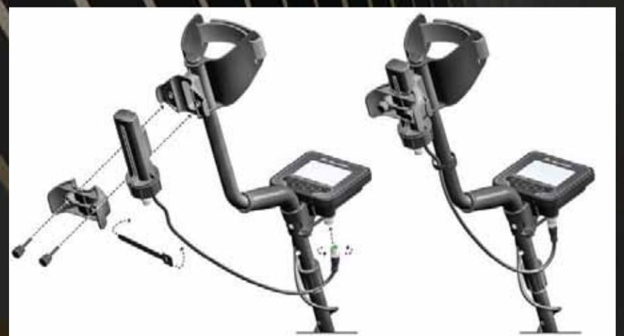
Das externe wasserdichte Batteriefach mit Montageanleitung.
