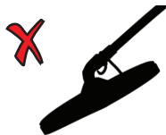
Неверный угол поисковой катушки к земле
