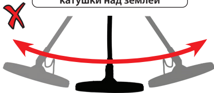
Неправильный проход катушки над землёй
