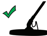
Правильный угол поисковой катушки к земле
