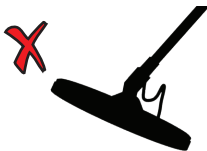
Неверный угол поисковой катушки к земле
