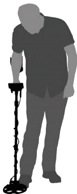
Высота штанги отрегулирована неверно
