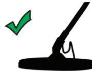
Angolo corretto della piastra di ricerca
