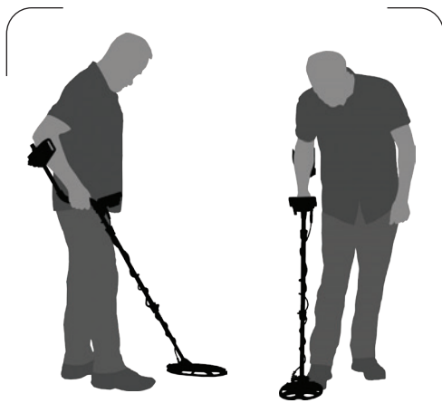
La lunghezza delle aste è errata
