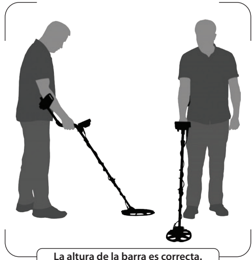
La altura de la barra es correcta.
