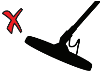
Ángulo incorrecto de la bobina de búsqueda
