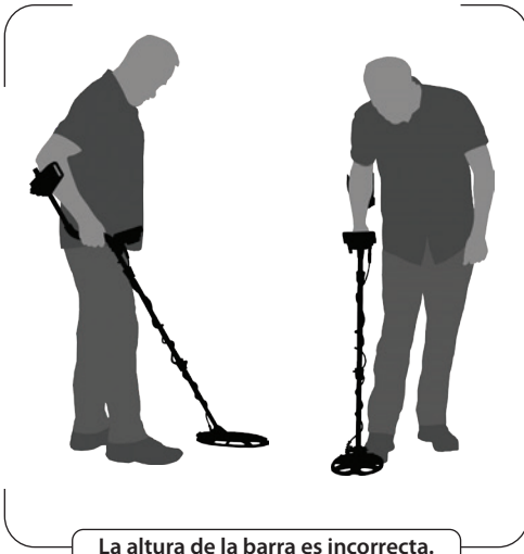
La altura de la barra es incorrecta.
