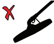
Ángulo incorrecto de la bobina de búsqueda
