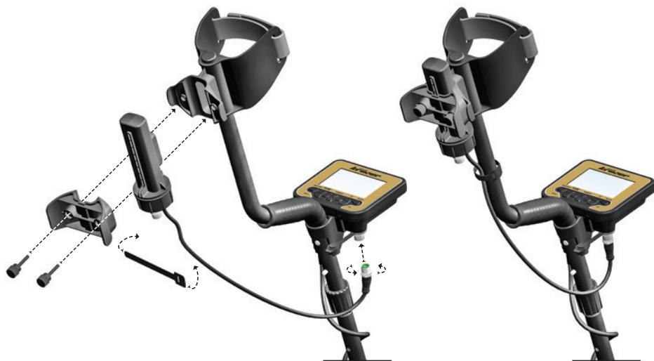
Батарейный отсек использует 4 алкалиновые AA-батареи или никель-кадмийевые (NiCd) / никель-металлогидридные (NiMH) аккумуляторы.
