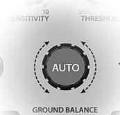
4. الموازنة الأرضية التقليدية : اضغط بشكل مطول على مفتاح الموازنة الأرضية الدائري المتعدد الوظائف ، و قم بتحريك قرص البحث مرارا و تكرارا باتجاه الاعلى و الاسفل بمقدار 3 سم - 10 سم (4-16 انش) فوق الأرض . حتى يقوم الكاشف بإصدار صوت تنبيه . يمكن إعادة العملية عدة مرات حتى يتم التأكد من اتمام عملية الموازنة بشكل سليم .
