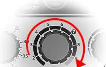
7. الحساسية: توفر زيادة للكشف على عمق اكبر ، ولكن أيضا ممكن ان يتزايد عدم الاستقرار في الاماكن ذات التمعدن العالى ، الكهربائية ، تردد الراديو (RF) او التداخل الكهرومغناطيسي . يجب تقلص الحساسية عندما تتسبب البيئة المحاطة او التمعدن العالى بضوضاء مفرطة ، وعدم الاستقرار، الكم الزائد ، يتدخل مع الاداء الأمثل للكاشف .
