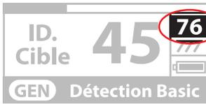
Le niveau de Minéralisation Magnétique varie de 0 à 99, et est affiché sur l'indicateur de Minéralisation Magnétique, sur la partie droite de l'écran principal. Cette mesure peut être résumée par le niveau de la propriété et de l'intensité magnétique du sol. Simplement, si vous travaillez sur un terrain avec des minéraux intenses et magnétiques, cette
