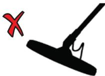
Mauvais angle de disque
